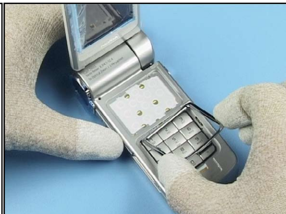
34. Use a new Bezel ITU to fix the keymat.
