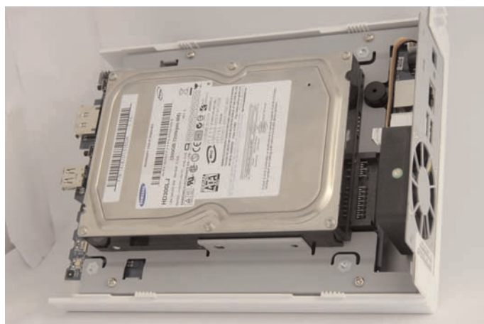
Аккуратно вставив диск в отсек, убеждаемся в его надежном подключении к соединительному разъему
