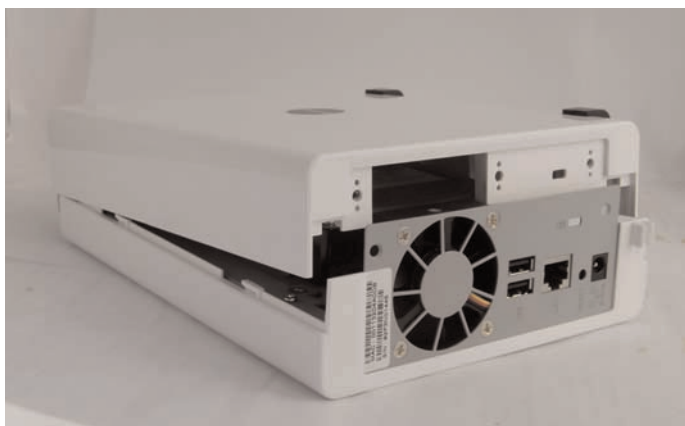
Чтобы вставить диск, следует разобрать корпус, сдвинув крышку устройства и сняв ее
