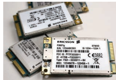
Повышенный уровень интеграции модуля Ericsson F3607gw сокращает количество компонентов и как следствие — стоимость решения
