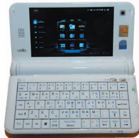
С одной стороны от дисплея находится встроенный громкоговоритель, с другой — веб-камера с разрешением 1,3 Мпикс
