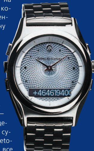
Часы, которые сообщают о входящем вызове посредством вибрации, а также показывают имя звонящего или его номер: Sony Ericsson Bluetooth-Watch MBW-200
