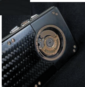
Первая в мире модель кинетического смартфона, способного заряжаться от встроенного генератора
