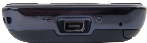
Чтобы облегчить жизнь пользователю, производитель оснастил Pharos стандартным разъемом miniUSB
