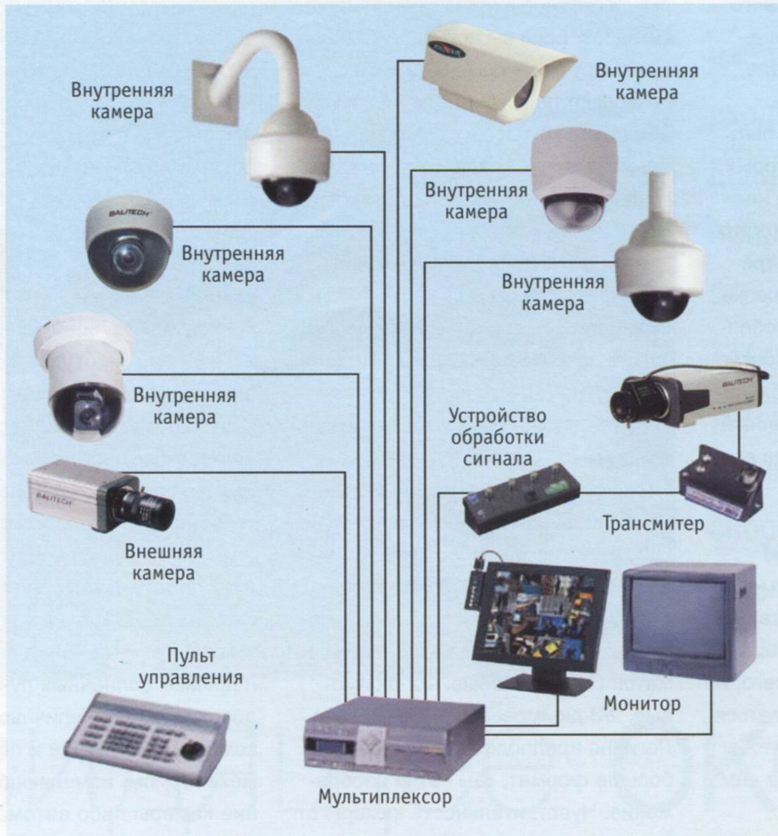
Самая простая схема сети видеонаблюдения состоит из внешних и внутренних камер, мультиплексора и мониторов
