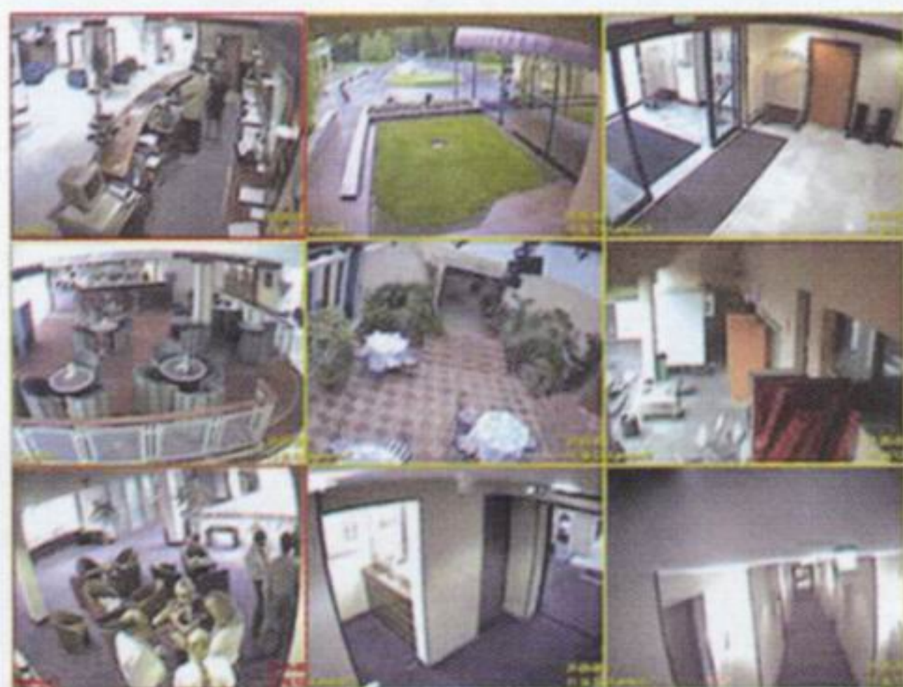
Квадратор работает по одному из алгоритмов: либо он равномерно транслирует все изображения на экран, либо отдает предпочтение одной камере
