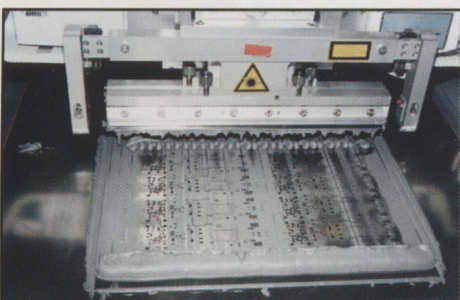
10 Станок накатывает на плату специальное токопроводящее вещество, на которое потом "приклеиваются" самые мелкие детали.
