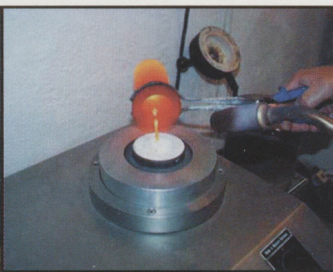
Технология производства золотого корпуса довольно проста: ювелир заливает расплавленный металл в форму, затем остужает, полирует и устанавливает на мобильный телефон
