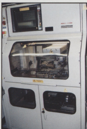
15 Здесь блок (см. рис. 13) разрезают на восемь плат.
