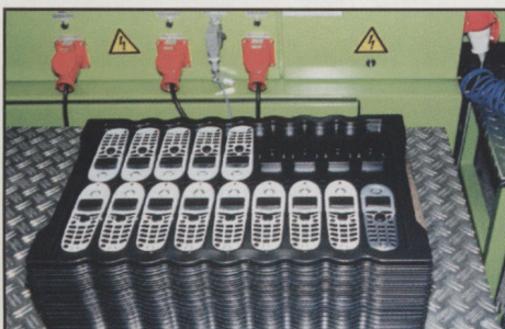
7 Затем их складывают на такие палеты и отправляют по конвейеру дальше.
