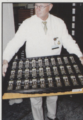
16 ...и раскладывают в палеты (как и корпуса). Кстати, работоспособность электроники автоматически проверяется прямо в процессе производства, так что брака здесь уже нет.
