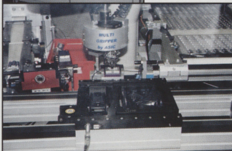
17 Последний этап — сборка. На этом участке в трубки устанавливают клавиатуры и стекло, закрывающее дисплей. Далее ставят контакты для батарей, монтируют плату с электронной начинкой и...
