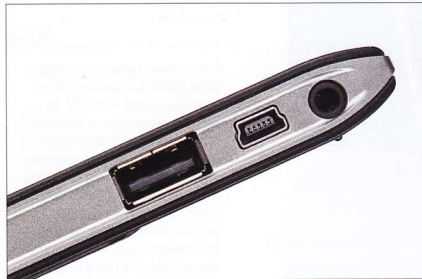
Рядом с разъемом miniUSB расположена гнездо USB-хоста, с помощью которого можно подключить USB-флешку и другие устройства, получив доступ к их файлам напрямую из ридера.
