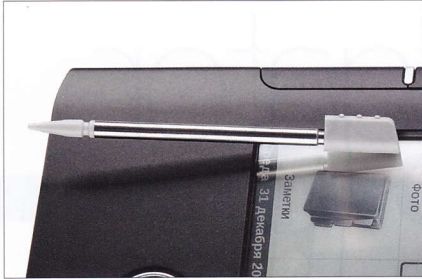
Телескопический стилус PocketBook в разложенном виде длиннее своего конкурента, к тому же вынимается не в пример легче, и тем не менее вряд ли покинет свое гнездо самостоятельно.
