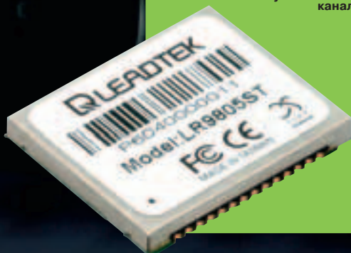
Чип SiRFstarII поддерживает связь со спутниками по 12 каналам
