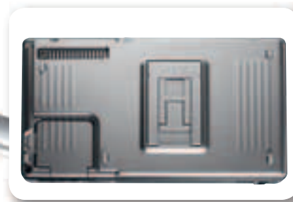
На задней панели помещаются откидная опора для удержания устройства на столе в наклонном вертикальном положении и антенна модуля глобальной навигации
