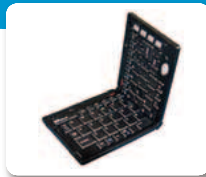
В комплекте поставляется складная полнофункциональная клавиатура, подключаемая к разъему mini-USB
