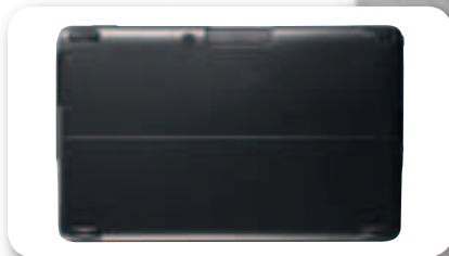
Сзади половину площади занимает аккумуляторная батарея. Справа от нее имеется пенал для стилуса, причем последний извлекается после надавливания
