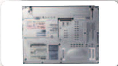
Снизу предусмотрены люк для доступа к модулю оперативной памяти и «гребенка» для подключения к док-станции
