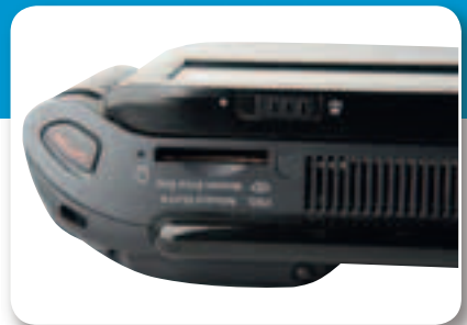
Сверху обнаруживаются кнопка спуска затвора и переключатель режима макро основной камеры, а также слот карт-ридера Memory Stick
