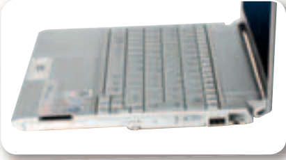
Справа установлены карт-ридер, мультимедийный оптический привод с поддержкой двухслойной записи, слот для PC Card, механический выключатель беспроводного адаптера, один из портов USB, коннектор RJ-45 и крепление замка Кенсингтона
