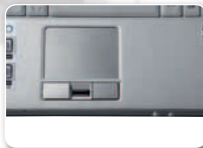
Тачпад крупный, с удобной рабочей поверхностью. Между его кнопками расположен сканер отпечатков пальцев
