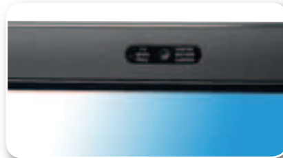
Над дисплеем установлена миниатюрная веб-камера для видеоконференц-связи
