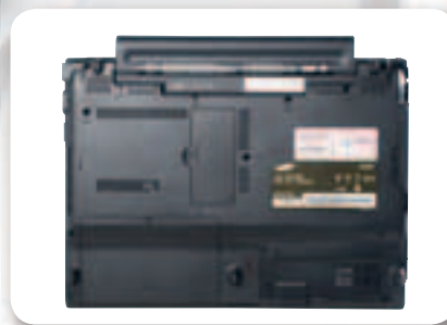
Снизу предусмотрены люки для доступа ко всем компонентам электроники и оснастки, подлежащим замене или апгрейду
