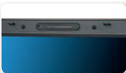
Над дисплеем установлена веб-камера с разрешением сенсора 0,3 млн. пикселей
