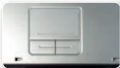
Тачпад снабжен кнопками необычной конструкции, работать с которыми несколько неудобно из-за значительного люфта
