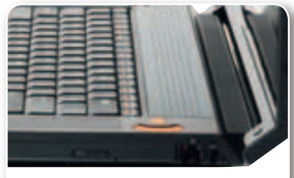
Справа от клавиатуры размещаются оранжевые кнопки запуска медиапроигрывателя и управления громкостью
