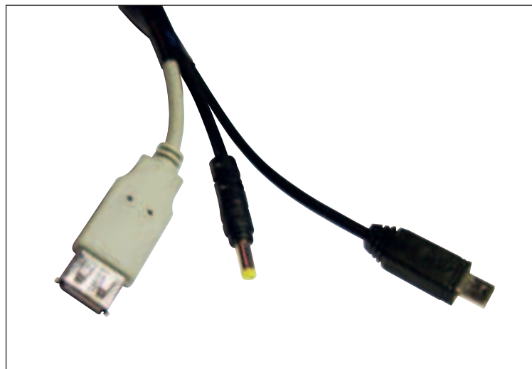
Тот, кто грузит с паяльником, сможет соорудить multifunctional адаптер. Главное - не заряжать одновременно несколько устройств.
