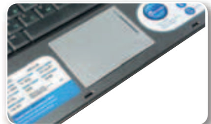
Тачпад с удобной рабочей поверхностью и зоной вертикального скроллинга содержимого окон приложений снабжен «слив-шимися» кнопками
