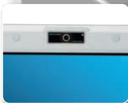
Над дисплеем установлена миниатюрная веб-камера с разрешением сенсора 1,3 млн. пикселей
