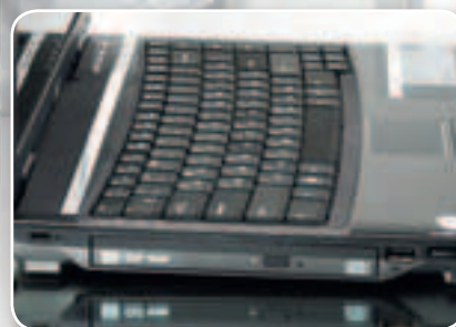
На левой боковой панели расположены крепление замка Кенсингтона, мультиформатный DVD-рекордер, один порт USB и карт-ридер
