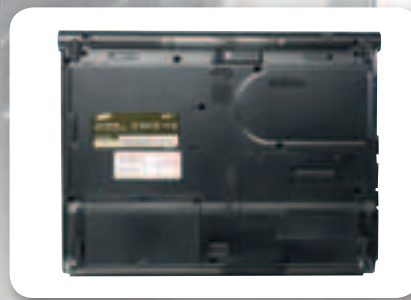
Снизу предусмотрены люки для доступа ко всем компонентам электроники, подлежащим замене или апгрейду
