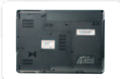
Снизу предусмотрены люки для доступа ко всем компонентам электроники, подлежащим замене или апгрейду
