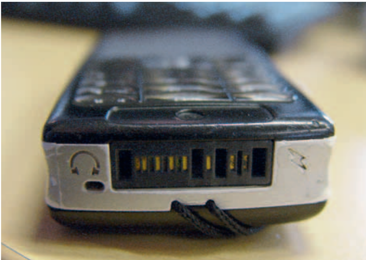
Разъем такого типа подвержен загрязнению. А потеря контакта может быть ошибочно расценена как поломка зарядного устройства.
