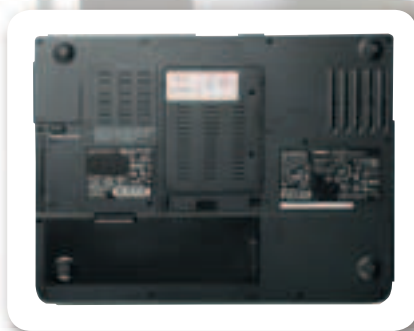
Снизу предусмотрены люки для доступа к модулям оперативной памяти и отсеку с жестким диском
