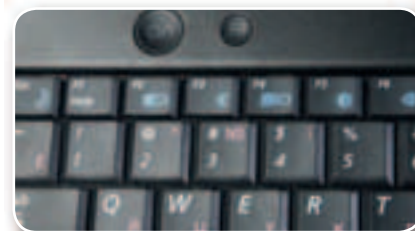
Клавиши клавиатуры имеют наносеребряное покрытие, обладающее антибактериальным действием
