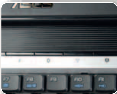
Над клавиатурой находится блок кнопок для управления аппаратными компонентами системы
