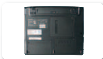
Снизу предусмотрены люки для доступа к модулям оперативной памяти, жесткому диску и адаптерам PCI. Батарея снабжена светодиодными индикаторами заряда
