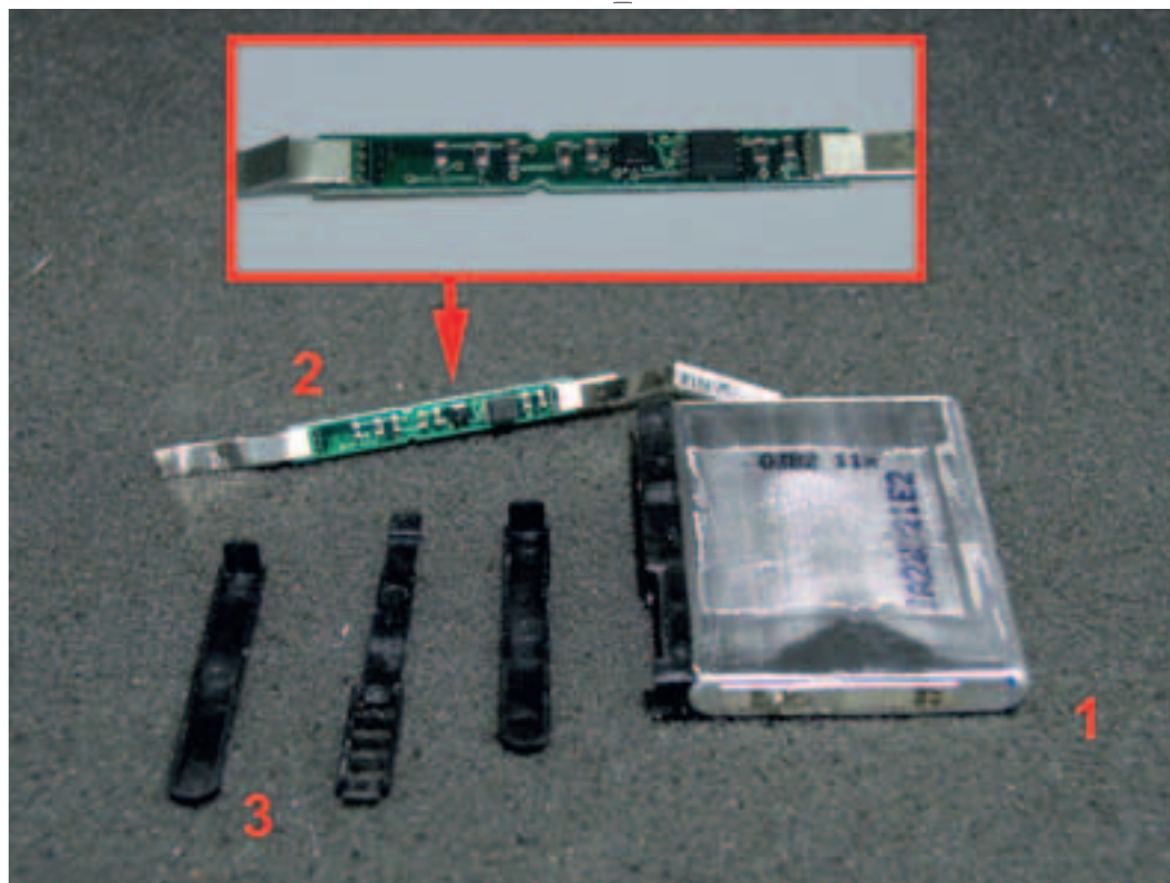
Рис. 3. Внутреннее устройство аккумулятора КПК HP iPAQ h1940
