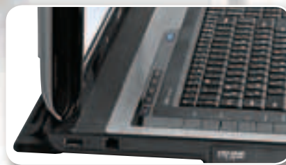
На левой боковой панели расположены один порт USB, коннектор RJ-11, оптический привод HD DVD
