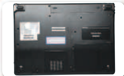
Снизу предусмотрен люк для доступа только к модулям оперативной памяти
