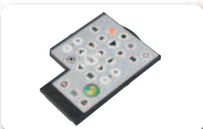
В комплект поставки входит миниатюрный пульт ДУ, который прячется в слоте для Express Card
