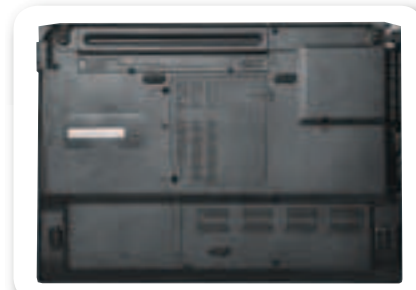
Снизу предусмотрены люки для доступа к модулям оперативной памяти и жесткому диску
