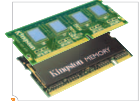
3 Модули SO-DIMM отличаются количеством контактов и расположением прорези. У SDRAM прорезь ближе к центру, а у DDR и DDRII — ближе к краю
