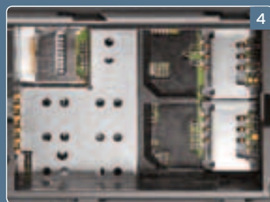
4 Слот microSD (поддерживается объем до 2 Гбайт) размещен под аккумулятором: о горячей замене карты можно забыть
