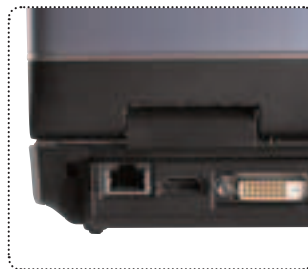
Сзади имеются разъем RJ-45, интерфейс HDMI и видеовыход DVI
