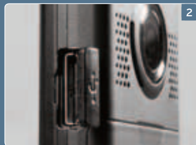
2 Телефон может работать как Web-камера или GPRS-модем. Разъем для USB-кабеля находится на правом боку устройства
