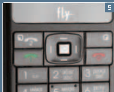
5 Аппаратные кнопки при поступлении звонка на вторую SIM-карту дублируют кнопки приема и сброса вызова
