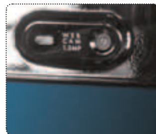
Над дисплеем установлена мини-атюрная Web-камера с разрешением сенсора 1,3 млн. пикселей
