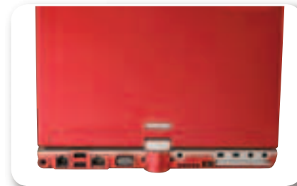
На задней панели сосредоточены все интерфейсы: аудиоконнекторы, 2 порта FireWire, слот PCMCIA Type II, видеовыходы композитный (RCA) и VGA, разъемы RJ-45 и RJ-11, 2 коннектора USB и гнездо для подключения адаптера питания
