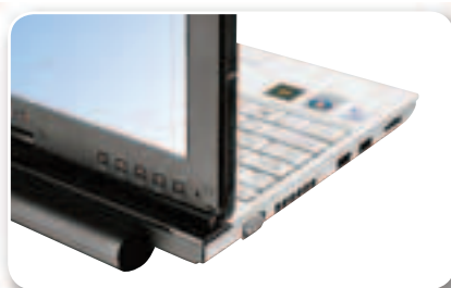
Слева находятся видеовыход VGA, два порта USB и выключатель питания
