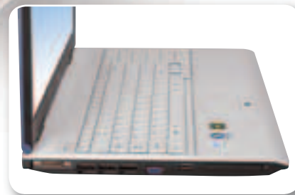
Слева находятся «гребенка» док-станции, видеовыход VGA, один порт USB и слот для PC Card
