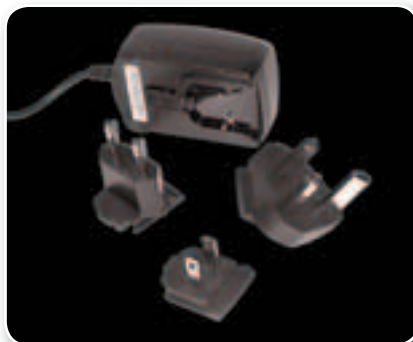
Вместо того чтобы укомплектовать КПК тремя разными сетевыми адаптерами, производитель предпочел вложить в коробку один универсальный, но с тремя насадками разных стандартов
