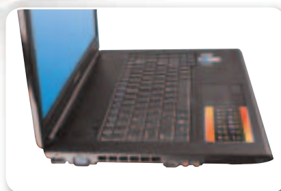
Слева находятся один из портов USB, видеовыход VGA, интерфейс HDMI, аудиоконнекторы и слот для PC Card
