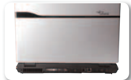
На заднюю панель выведены видеовыходы DVI и VGA (D-Sub), гнездо для подключения адаптера питания, коннекторы RJ-11 и RJ-45, а также еще два порта USB
