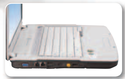
Слева расположены видеовыходы VGA и S-Video, коннекторы RJ-45 и RJ-11, три порта USB, интерфейс HDMI, разъем mini-FireWire и слот для Express Card
