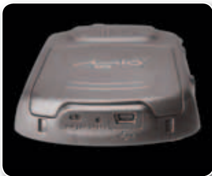
Соединение с компьютером осуществляется через USB. Этот же интерфейс служит для подключения внешнего источника питания
