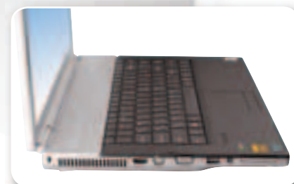
Слева находятся крепление для замка Кенсингтона, интерфейс HDMI, видеовыходы S-Video и VGA, один порт USB, разъем mini-FireWire и слот для Express Card
