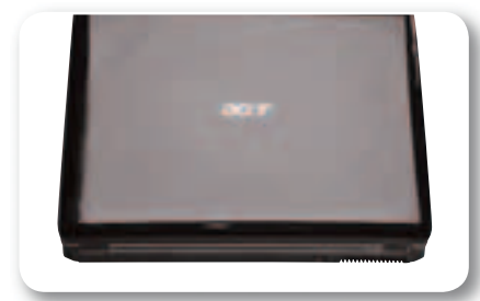
На заднюю панель выведены лишь решетка выходного отверстия системы охлаждения и гнездо для подключения адаптера питания
