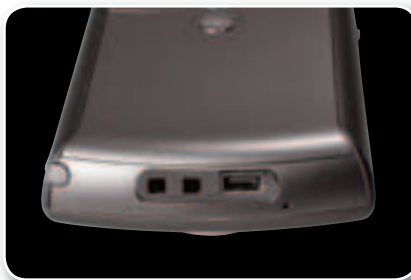
Зарядное устройство, кабель синхронизации с ПК и гарнитура подключаются через порт mini-USB. 2,5-миллиметрового разъема для наушников не предусмотрено
