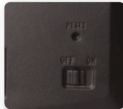
Рядом с выключателем питания на тыльной стороне навигатора расположена кнопка перезагрузки
