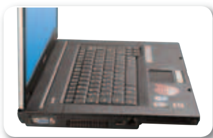
Слева находятся видеовыход VGA, порт USB, разъем RJ-11 и слот для PC Card
