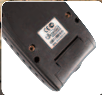
Слот для карт памяти SD и mini-USB-коннектор спрятаны под крышечкой, расположенной в нижней части навигатора
