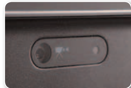
Над дисплеем установлена встроенная Web-камера, с помощью которой можно проводить видеоконференции и общаться посредством приложений VoIP (например, по Skype)
