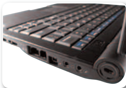
Справа имеются два коннектора USB, разъемы RJ-45, RJ-11 и mini-FireWire, а также аудиоконнекторы
