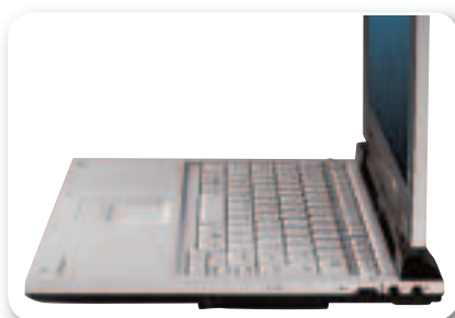
Справа установлен слот для PC Card, механический регулятор громкости и аудиоконнекторы
