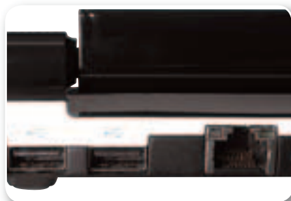
Сзади находятся разъем RJ-45 и два порта USB
