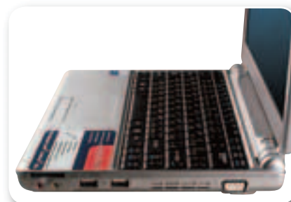
Справа установлены карт-ридер, аудиоконнекторы, два разъема USB и видеовыход VGA
