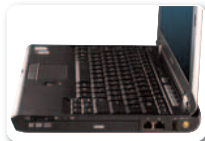
Справа установлены один из портов USB, коннекторы RJ-11 и RJ-45, мультимедийный DVD-рекордер, выключатель адаптера беспроводной связи и карт-ридер
