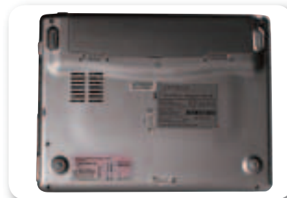
Большую часть задней панели занимает стенка батареи. Слева от нее выведено гнездо для подключения источника питания
