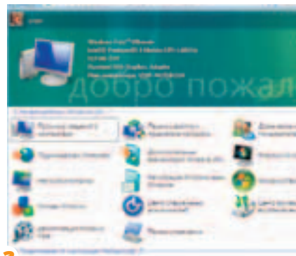
2 Параметры Windows Vista проще всего указать в окне «Центра начальной настройки», вызываемого из «Панели управления»
