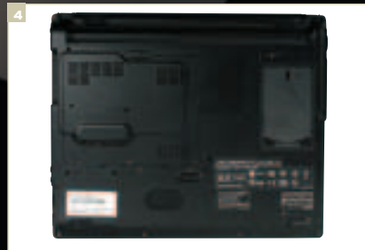
На нижней поверхности имеются инженерные люки для доступа к внутренним компонентам системы, позволяющие производить апгрейд без разборки корпуса
