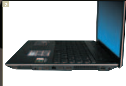
Справа находятся четыре порта USB, карт-ридер, аудиоконнекторы, разъемы RJ-11 для подключения модема к телефонной линии и RJ-45 локальной сети Ethernet
