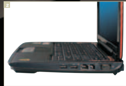
На правой боковой панели разместились два оставшихся коннектора USB, разъемы RJ-45 (LAN) и RJ-11 (модем), а также видеовыход VGA
