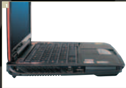
Слева расположены крепление замка Кенсингтона, порт FireWire, один из разъемов USB и слот для PC Card, используемый для расширения системы
