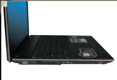
На левой боковой панели расположены крепление замка Кенсингтона, видеовыход VGA, разъем mini-FireWire, ИК-порт и оптический привод
