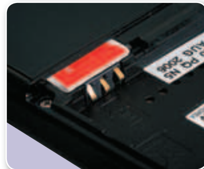
Для того чтобы заменить SIM-карту, придется открыть крышку телефона, вынуть батарею и только после этого извлечь ее. И это несмотря на то, что слот карты вынесен из-под аккумулятора
