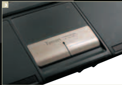
Тачпад у «Феррари», весьма оригинальный по внешнему оформлению, но достаточно комфортный в использовании, снабжен зоной вертикального скроллинга
