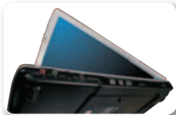
Справа установлены аудиоконнекторы, разъем mini-FireWire, два интерфейса USB и мультимедийный оптический привод, поддерживающий запись на двухслойные DVD
