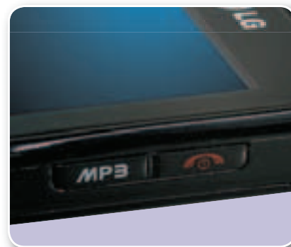
Кнопка сброса вызова (она же кнопка выключения девайса) потеряла место на основной лицевой панели и переместилась на боковую. Немного неудобно, особенно тем, кто часто ею пользуется
