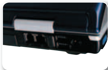
Сзади размещены разъем S-Video и линейный аудиовыход, коннекторы RJ-11 для подключения модема к телефонной линии и RJ-45 локальной сети Ethernet, два интерфейса USB и гнездо адаптера питания
