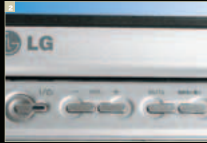
2 Рядом с кнопкой включения ноутбука находятся клавиши регулировки громкости и включения режима объемного звучания SRS WOW
