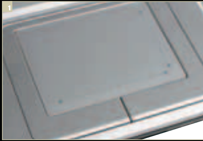
1 Тачпад оснащен выделенными зонами вертикальной и горизонтальной прокрутки. Кнопки под ним имеют оригинальную форму
