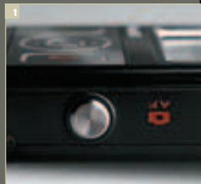
1 Кнопка активации цифровой камеры сделана рельефной, чтобы не промахнуться в экстремальных условиях
