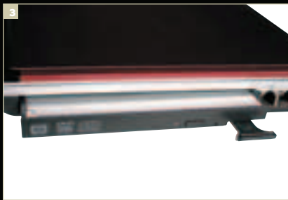
3 В ноутбуке реализована возможность извлечения оптического привода и замены его заглушкой для облегчения веса
