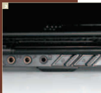
На переднем торце находятся аудиоразъемы и два механических переключателя. Первый для Bluetooth, второй для Wi-Fi
