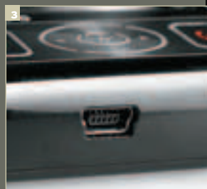
3 Для зарядки и соединения с компьютером коммуникатор оборудован разъемом mini-USB. Это очень удобно — избавляемся от лишних проводов
