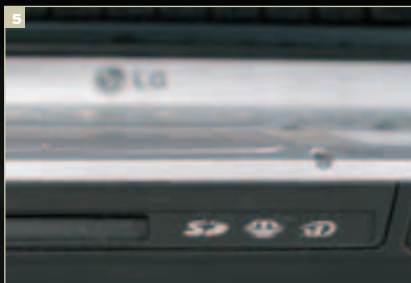
5 На передней боковой панели между встроенными динамиками находится карт-ридер, работающий с носителями SD/MMC, MS/MS PRO и xD-Picture
