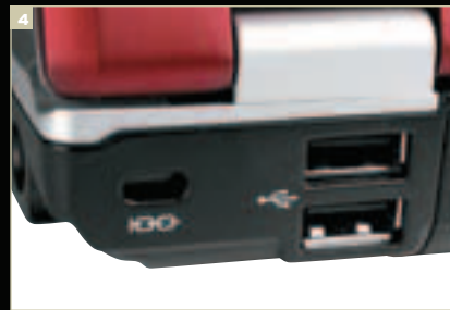
4 На задней панели расположены 2 порта USB для подключения внешних устройств
