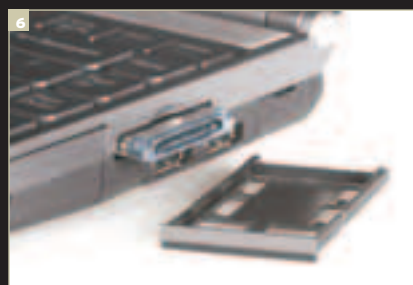
6 С помощью специального универсального адаптера карт-ридер, расположенный на правой боковой панели, может работать не только с «фирменными» устройствами MS или MS PRO, но также с SD/MMC и xD-Picture
