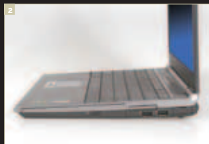
2 На правой боковой панели ноутбука под специальной крышечкой имеются коннекторы RJ-45 (подключение к локальной сети) и RJ-11 (подключение модема к телефонной линии), 2 порта USB и DVD-рекордер
