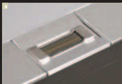
5 Между кнопками тачпада располагается биометрический датчик, обеспечивающий ограничение доступа к ноутбуку. Идентификация пользователя происходит путем дактилоскопического сканирования
