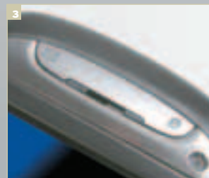
3 Левый индикатор отвечает за работу радиоустройств (Bluetooth, Wi-Fi), правый — за питание и подключение к компьютеру. Над ними располагаются клавиши для вызова интернет-приложений.
