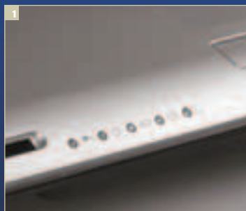
1 Расположение светодиодных индикаторов, отображающих состояние регистров и активность жесткого диска, выбрано удачно: они хорошо видны даже при закрытой крышке
