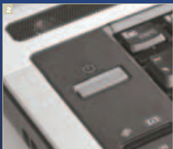
2 Кнопка включения имеет собственный индикатор, который сигнализирует о режимах работы компьютера и уровне заряда батареи разными цветами, постоянным свечением или миганием
