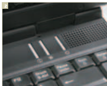
Серебристые кнопки отчетливо выделяются на фоне черного корпуса. Форма их такова, что нажатие нужно производить ногтем или утапливать палец довольно глубоко
