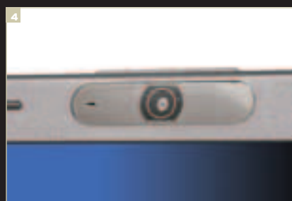
4 Над экраном помещается встроенная камера, позволяющая фотографировать с разрешением мобильного телефона. Ее главное назначение — организация web-конференций
