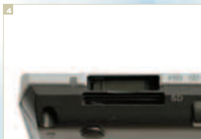
Слева на передней панели имеются слоты карт-ридера, предназначенные для носителей MS/MS PRO и SD/MMC, а также светодиод активности этих карт, сигнализирующий о записи или чтении данных
