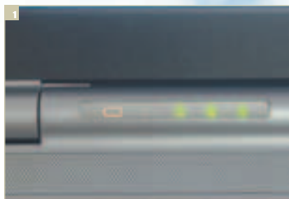
Светодиодные индикаторы, расположенные под дисплеем слева, имеют приятную подсветку и цвет, причем последний у пиктограммы заряда батарей меняется в зависимости от остатка энергии
