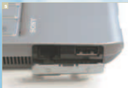
На левой боковой панели находятся один из двух портов USB и разъем RJ-11 для подключения модема к телефонной линии, прикрытые заглушкой (видимо, частое использование ни к чему)
