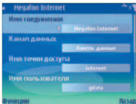
Для того чтобы подключить смартфон к Интернету, надо настроить точку доступа. На экране указаны настройки подключения для абонентов Мегафона. Пароль пользователя «gdata» не поместился на экране.
