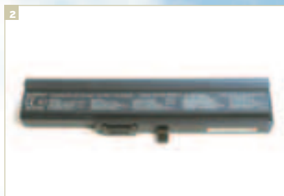
Съемная батарея VGP-BPS5 обладает достаточно высокой емкостью (7800 мАч) и сравнительно невелика по размерам. Это позволяет увеличить время автономной работы без утяжеления ноутбука
