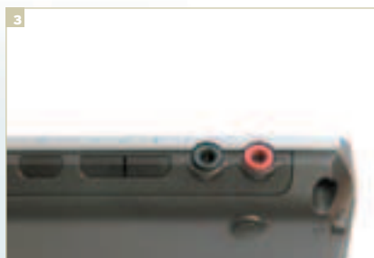
На переднем торце справа установлены: выключатели беспроводных адаптеров и встроенной акустики, механический регулятор громкости, разъемы для подключения наушников и микрофона
