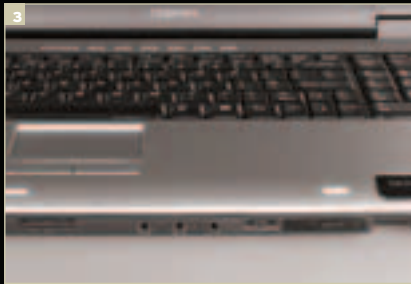
3 Аудиоразъемы вынесены на переднюю панель. А рядом с ними расположен механический регулятор громкости — давняя «фирменная» деталь портативных компьютеров от Toshiba
