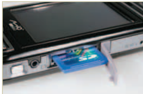
С правой стороны расположены основные элементы расширения функций: разъем флеш-карт, закрытый резиновой заглушкой, которая закреплена и уж точно не потеряется, выход для подключения стереогарнитуры и кнопка пуска фото. При использовании чехлом пользователю доступна лишь кнопка работы с камерой.
