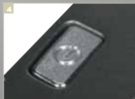
4 Такое расположение кнопки позволяет быстро управлять питанием компьютера в режиме навигации, но «подставляет» ее под несанкционированные нажатия
