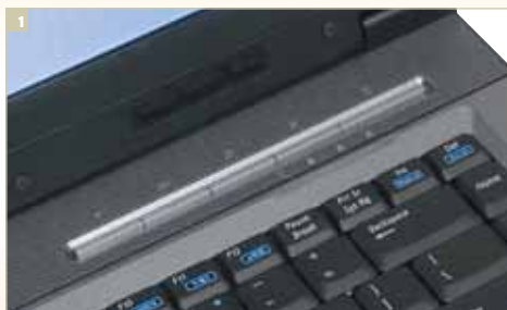
1 Под дисплеем находятся «горячие» клавиши вызова приложений и кнопка включения ноутбука
