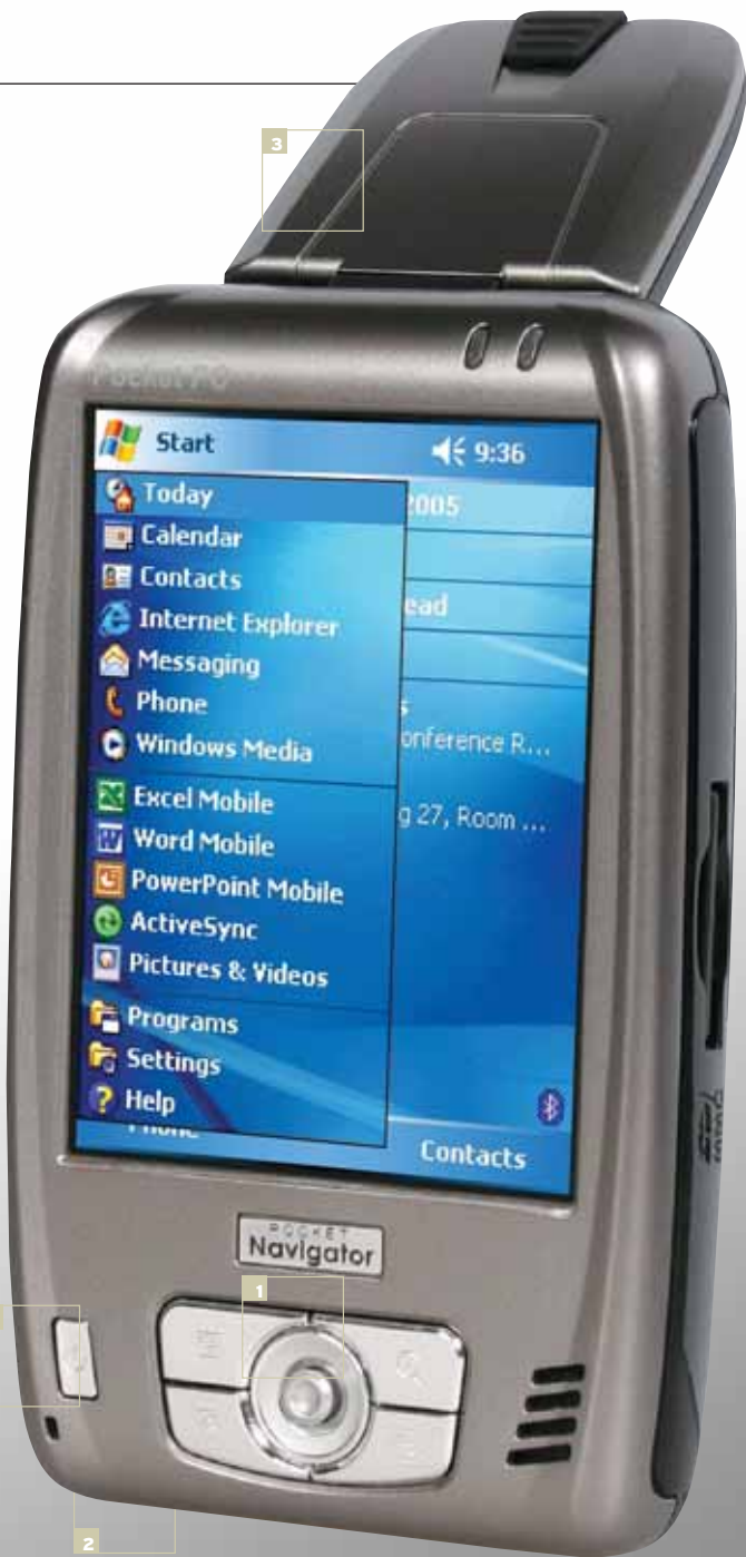
1 Кнопки, соседствующие с джойстиком, отмечены необычными пиктограммами, но их можно перепрограммировать так, как удобно вам
