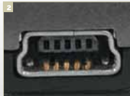
2 Это одна из самых приятных фиц в новом карманном ПК. Через этот порт можно синхронизировать и подзаряжать наладонник
