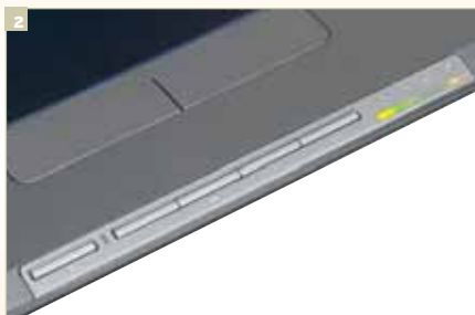
2 Из-под крышки выступают кнопки управления проигрыванием CD и блок светодиодных индикаторов
