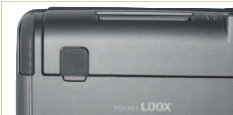
Можно подключить внешнюю антенну — на задней панели есть разъем. Но большой необходимости в этом нет, поскольку SiRF Star III и так обладает высокой чувствительностью
