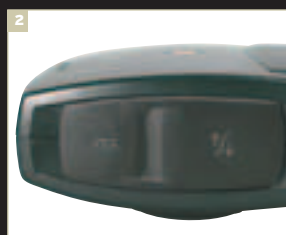
За резиновыми накладками скрываются разъемы питания и подключения последовательного интерфейса
