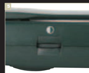
Контраст изображения на дисплее регулируется с помощью вот этого милого колесика, а никак не программно
