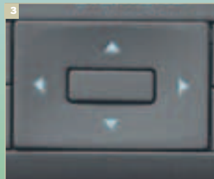
3 В джойстике расположен динамик — довольно удачное инженерное решение, призванное минимизировать загроможденность лицевой панели
