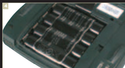
Аккумуляторы объединены в батарею с помощью алюминиевой скобы. Счастливые обладатели пассажиз могут попробовать ее разогнуть и вставить новые аккумуляторы вместо отживших свое.
