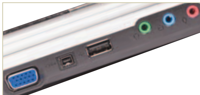
Левый торец ноутбука объединил mini-FireWire, D-Sub, порт USB и звуковые разъемы. Последние в данном случае можно было бы расположить и на передней панели, но расположение оных слева ничуть не мешает работе.
