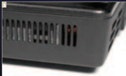
Чем мощнее система, тем больше тепла она выделяет. А что охладит лучше медного радиатора и хорошей вентиляции? Графический чип и центральный процессор располагаются под массивными медными радиаторами, которые предотвращают их перегрев
