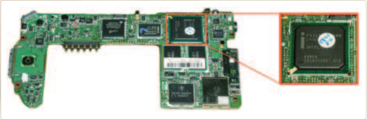
Основные микросхемы КПК Pocket LOOX 420
