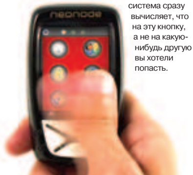
2 При разговоре по телефону нужно прижимать его к уху тыльной стороной — так расположены динамики и микрофон
