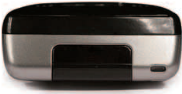
На верхнем торце устройства находится порт инфракрасной связи. Следует сказать, что в i300 присутствует и модуль Bluetooth 1.2.
