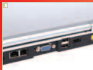
3 На задней панели виден ряд интерфейсных разъемов, в том числе 3 порта USB
