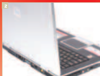
2 С левого бока установлены 2 аудиоразъема, один порт USB, FireWire, а также карт-ридер и интерфейс PC Card
