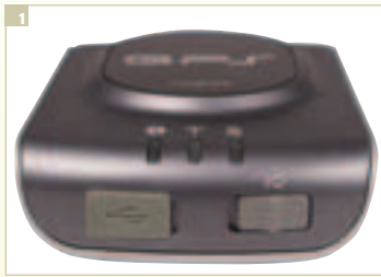
1 Разъем mini-USB и переключатель питания. Первый, кроме всего прочего, предназначен для зарядки встроенного аккумулятора.
