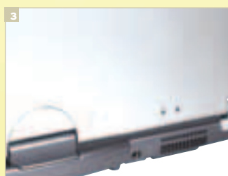
3 Решетка воздухозаборника «смотрит» вниз, поэтому место для установки ноутбука надо выбирать таким образом, чтобы она не была ничем закрыта
