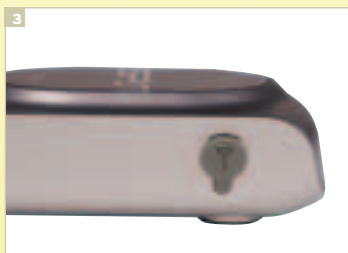
3 Стандартный разъем для внешней GPS-антенны. Очень полезная штука для качественного приема.
