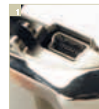
Порт mini-USB, который используется для синхронизации; защищен небольшой резиновой заглушкой
