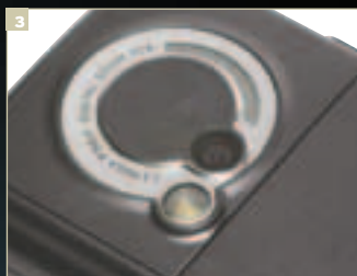
1,3-мегапиксельная камера с поддержкой 2-кратного приближения и яркой вспышкой позволяет получать снимки довольно приличного качества
