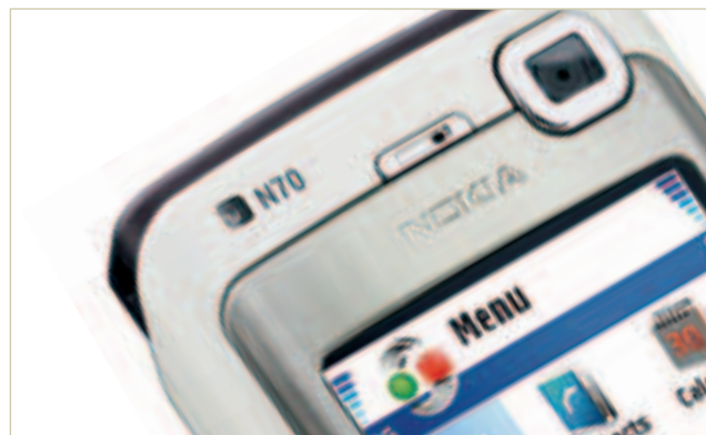
В зависимости от освещенности помещения светочувствительный сенсор на лицевой панели смартфона регулирует яркость дисплея, а также автоматически отключает подсветку кнопок клавиатуры
