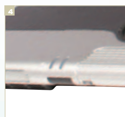
Индикатор и одновременно кнопка для активации беспроводного интерфейса
