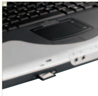
➔ На переднем торце ноутбука расположен слот для чтения карточек памяти стандарта SD/MMC
