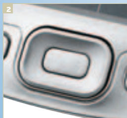
Очень удобный пятипозиционный джойстик замечательно ложится под палец и подойдет для работы и игр
