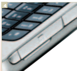
4 Слот расширения памяти расположен на торце аппарата, как и следовало ожидать, смартфон поддерживает только карточки с пониженным рабочим напряжением
