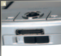
3 Переключатель батареи. Батарея съемная. Для ее извлечения существует специальный переключатель
