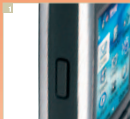
С левого торца 3230 находится кнопка для вызова функции Push-To-Talk
