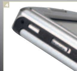
4 Кнопка Hold. Блокирует клавиши и отключает экран
