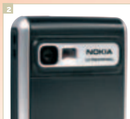
В смартфоне присутствует встроенная 1,2-мегапиксельная камера. По качеству съемки она значительно уступает своим аналогам 6630 и 6680.
