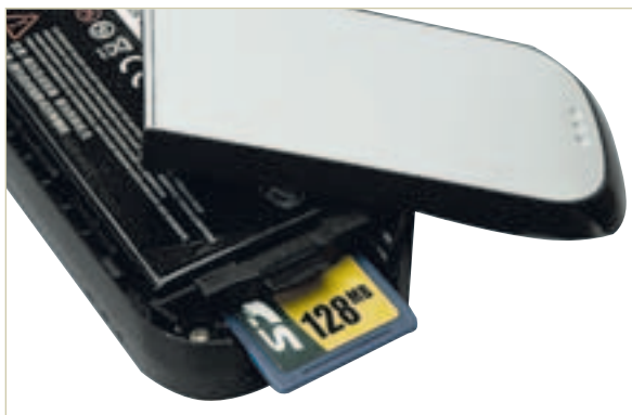
Расширить встроенную в смартфон память можно при помощи слота SD/MMC. К слову сказать, разъем для установки карточки находится под аккумулятором, что защищает его от грязи и пыли
