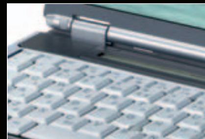
Небольшой ЖК-дисплей, заменяющий собой информационные светодиоды, — весьма удачное решение
