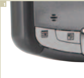
1 Расположение кнопки мягкой перезагрузки довольно нестандартно — на нижнем торце корпуса
