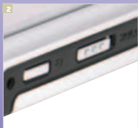
Клавиша включения, а также гнездо кнопки мягкой перезагрузки расположены на левом торце КПК
