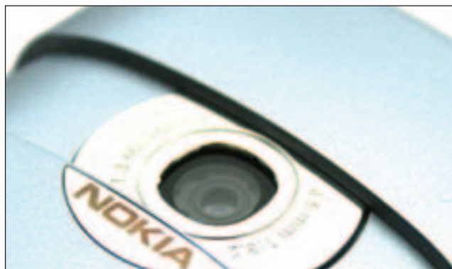
Сдвигной слайдер на обратной стороне смартфона открывает объектив встроенной камеры и активирует режим фотосъемки
