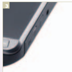
3 Тоненькие шторки, прикрывающие собой порты и разъемы, — взамен дешевеньких резинок и заглушек
