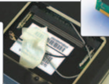
Беспроводной адаптер mini PCI и гнездо для его установки
