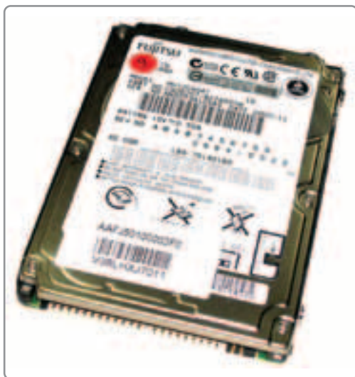
Нужно убедиться, что новый жесткий диск имеет подходящий интерфейс
