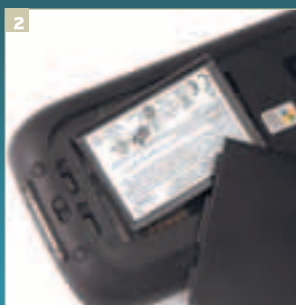
Аккумулятор у X50v съемный, и можно без проблем купить дополнительную батарею
