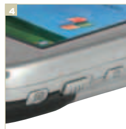
4 С правой стороны находятся удобный слайдер для регулировки громкости вызова, кнопка фотосъемки и клавиша записи
