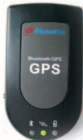
↑ Навигатор с Bluetooth можно разместить на расстоянии до 10 м от GPS-приемника
