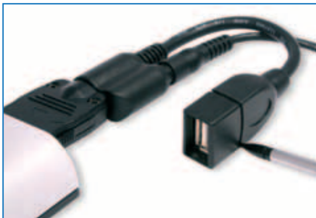
Один из проводов ведет к USB-порту, другой — к адаптеру питания переменного тока
