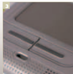
3 Благодаря резиновым вставкам палец легко находит клавишу и не соскальзывает с нее при нажатии
