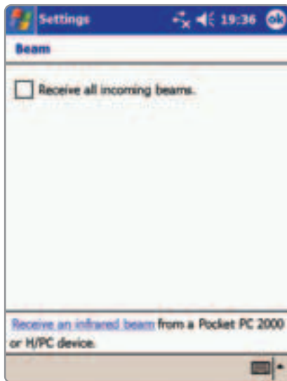
➤ Снимите галочку напротив Receive all incoming beams , чтобы отключить ИК-порт и избежать неоправданных потерь драгоценного заряда батарей.
