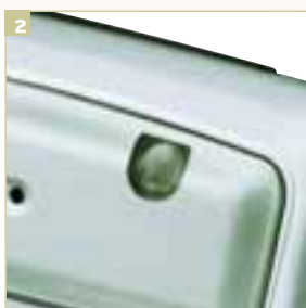
2 При помощи встроенного датчика освещенности смартфон активирует бело-лунную подсветку клавиатуры
