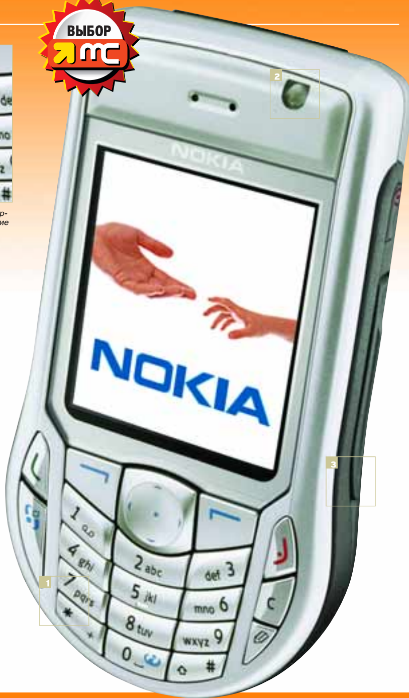
2 При помощи встроенного датчика освещенности смартфон активирует бело-лунную подсветку клавиатуры
