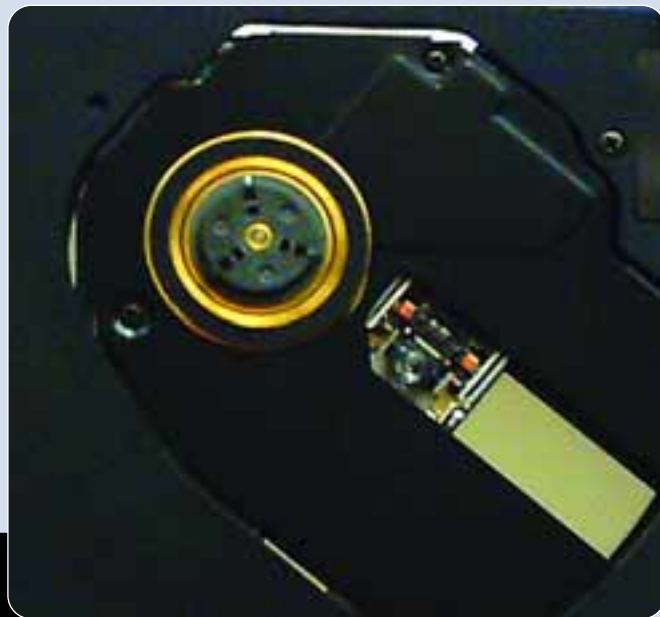
Запотевание линзы CD-ROM'a приводит к сбоям
