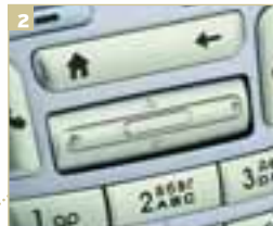
Оригинальная конструкция джойстика не обладает ощутимым направлением нажатия
