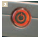
2 Кнопка включения при зарядке КПК мигает янтарным светом
