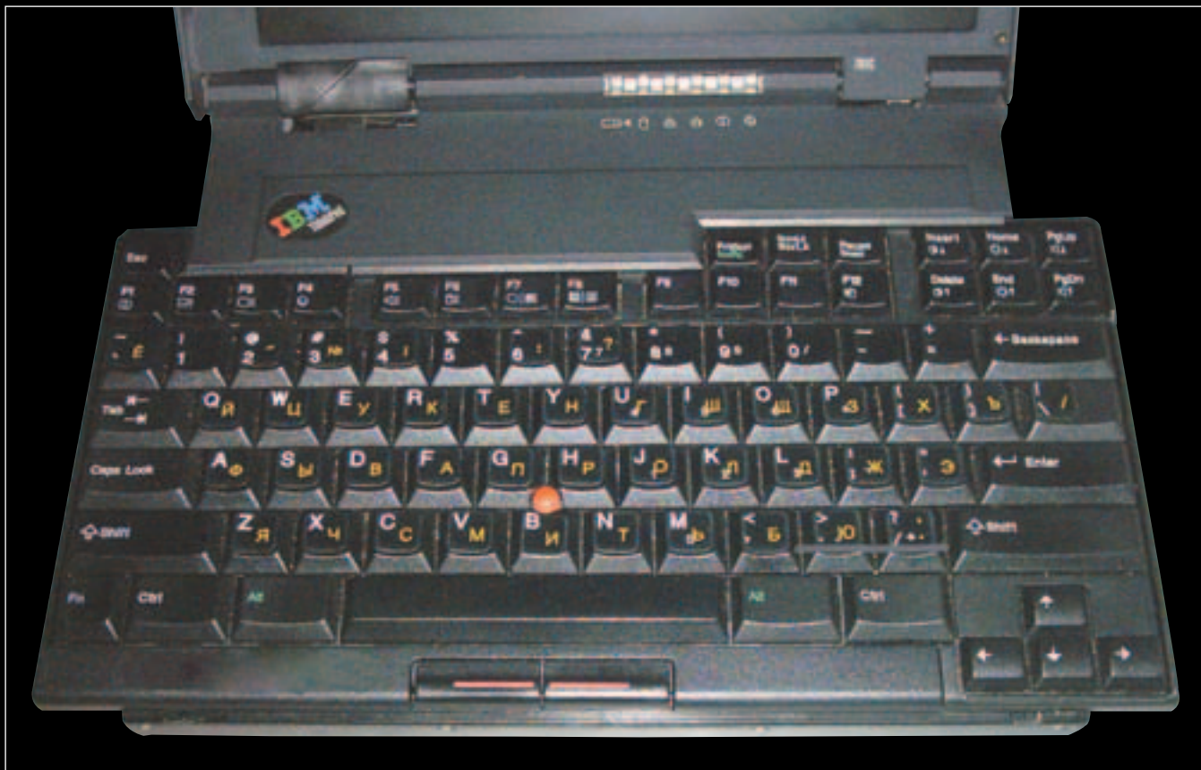
Клавиатура ThinkPad 701 шире корпуса на 47 мм
