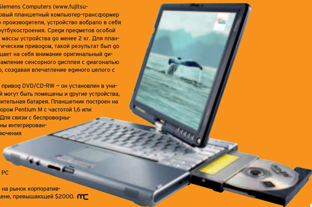
Fujitsu Siemens Lifebook T4010 – планшетник легче 2 кг со встроенным оптическим приводом
