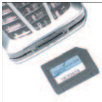
↑ В качестве сменных элементов памяти S65 использует RS-SD-карты, которые только размером отличаются от привычных SD/MMC-карт
