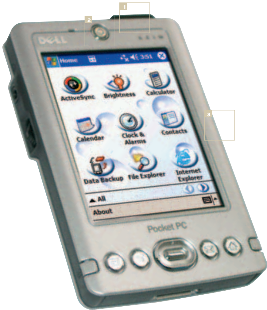
1 Небольшая антенна светится синим или зеленым цветом в зависимости от активного беспроводного протокола
