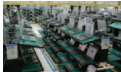
Писк и гул стоит нескончаемый – это проходят циклические тесты свежесобранные ноутбуки
