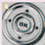
Навигационная клавиша представляет собой привычный пятипозиционный джойстик
