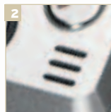
Встроенный микрофон позволяет разговаривать при помощи E-TEN P700 без использования гарнитур handsfree
