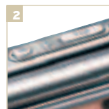
2 Клавиши управления съемкой расположены на боковых поверхностях телефона
