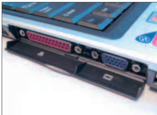
➤ Редко используемые VGA-выход на внешний монитор и параллельный порт принтера прикрыты откидывающейся пластмассовой крышкой
