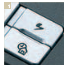
Эта кнопка запускает утилиту FSC SpeedMenu для быстрого запуска приложений и доступа к документам
