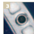
3 Рядом с «глазком» объектива расположены светодиоды (сигнальный и «вспышка»; второй может служить фонариком)
