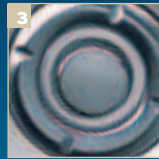
3 Управление осуществляется с помощью пятипозиционной клавиши, предусмотрительно чуть «утопленной» в корпусе
