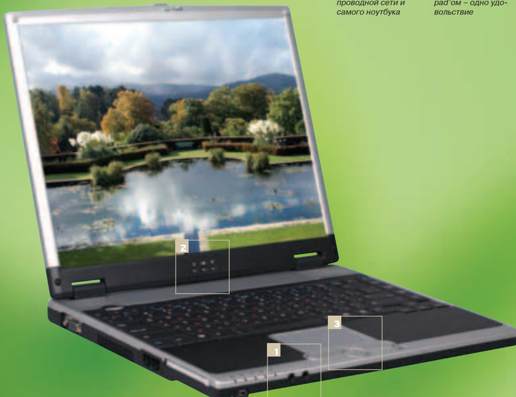
Основные статусные индикаторы выполнены сквозными – их видно как при открытой, так и при закрытой верхней крышке. Они отображают заряд батареи, а также статус работы беспроводной сети и самого ноутбука
