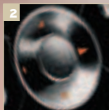
Пятипозиционный джойстик очень удобен для навигации, хотя, на первый взгляд, для управления «картуальным» меню больше подошло бы колесико
