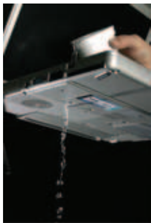
Жидкость, пролитая на клавиатуру Hawk, не причиняя вреда компьютеру, вытекает через специальное отверстие в нижней крышке корпуса.
