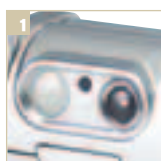
Камера снабжена размещенным рядом с объективом зеркальцем, которое при получении автопортретов служит видеоскателем
