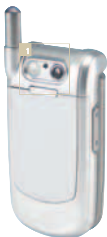
Камера снабжена размещенным рядом с объективом зеркальцем, которое при получении автопортретов служит видеоскателем
