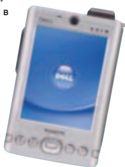
↑ Axim X3i оснащен встроенным адаптером беспроводной связи стандарта 802.11b (Wi-Fi) и внешней антенной
