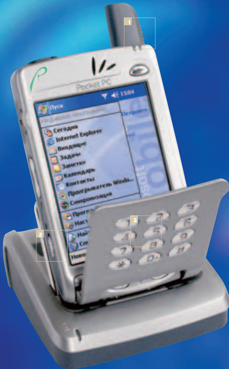
Блокировка кнопок включается аппаратным «ползунком»
