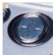
Управление курсором в MyPal A620BT выполняется с помощью такой же восьмипозиционной клавиши, как и в предыдущей модели
